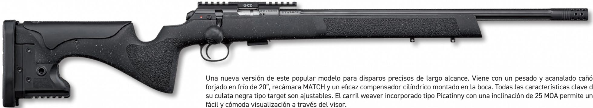
Una nueva versión de este popular modelo para disparos precisos de largo alcance. Viene con un pesado y acanalado cañón forjado en frío de 20", recámara MATCH y un eficaz compensador cilíndrico montado en la boca. Todas las características clave de su culata negra tipo target son ajustables. El carril weaver incorporado tipo Picatinny con una inclinación de 25 MOA permite una fácil y cómoda visualización a través del visor.
